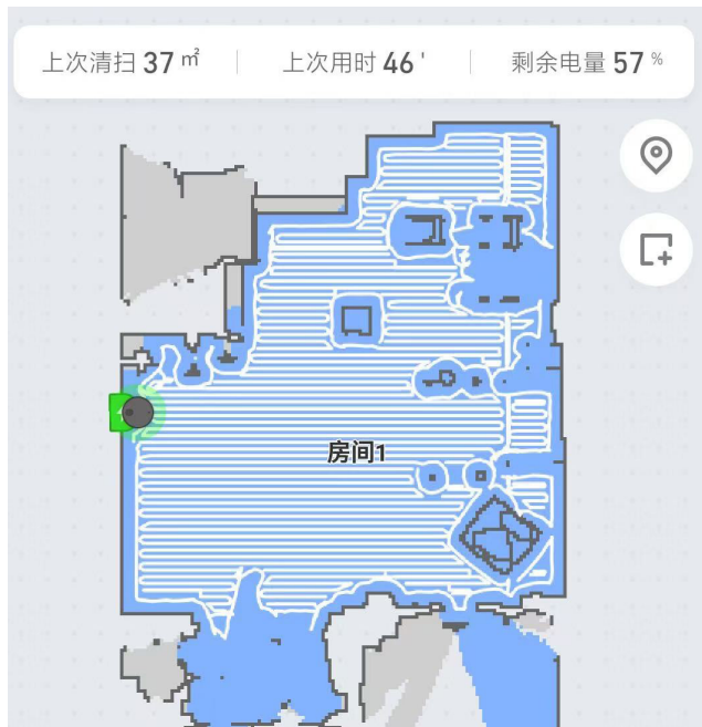
图2 激光雷达数据采集路径规划示意图
