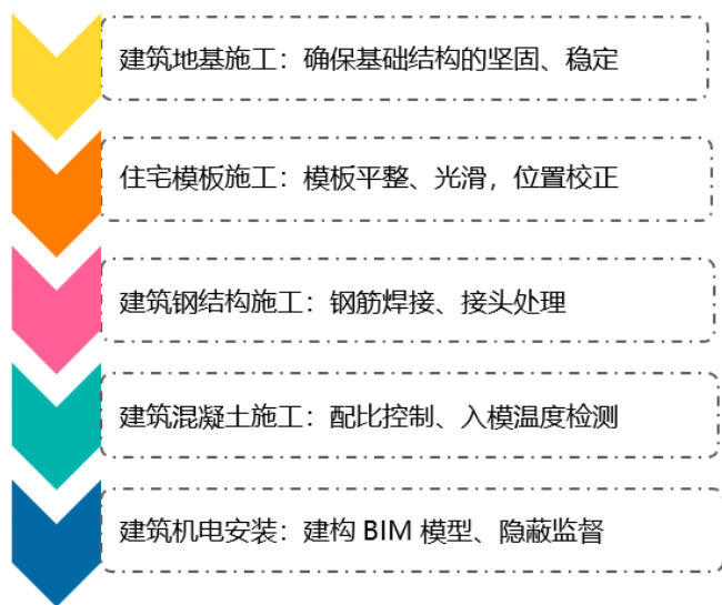
图1 住宅建筑现场施工的基本流程图
