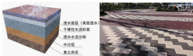
图2 透水铺装工作原理与施工效果示意图
