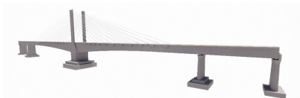
图 2.1 矮塔斜拉桥三维模型图
