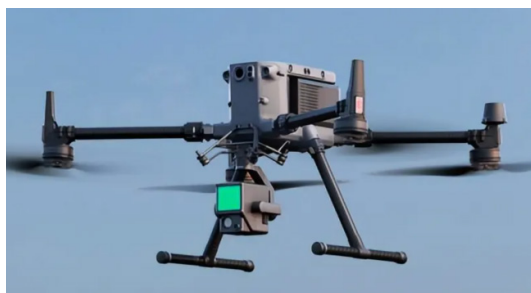
图2 三维激光扫描功能的无人机
