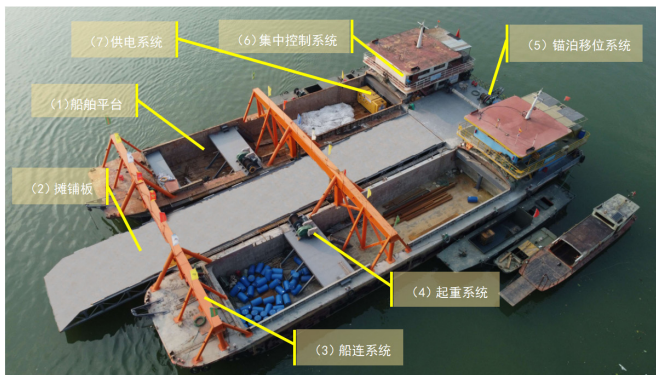
图五：深水护岸摊铺船
