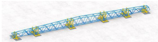
图 3 拼装胎架轴测示意图
