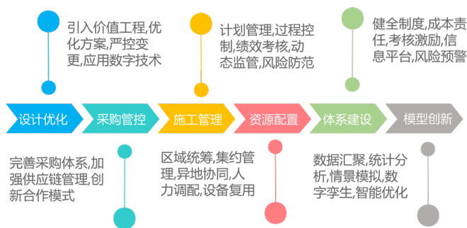
图 2 分布式光伏 EPC 总承包项目成本控制与优化路线图
