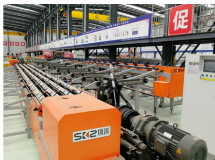
图 7 钢筋笼滚丝机器人
