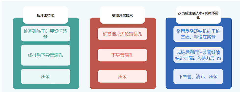
图 2 降低新旧桥梁沉降差新方法
