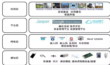
图1 物联网框架示意图
