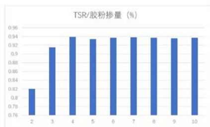
图1: 胶粉粒径与掺量对水稳定性的影响
