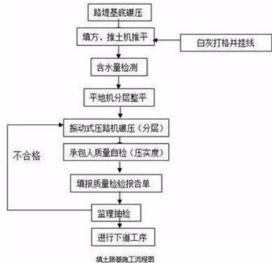
图1 填土路基施工流程图
