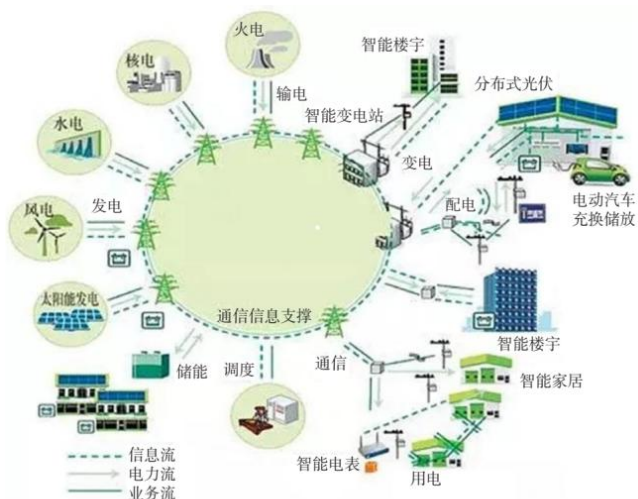
图1 智能电网系统示意图
