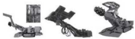
图1掘进机机载式超前临时支护系统
