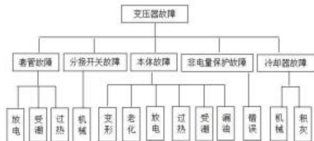
图1 变压器故障树结构图
