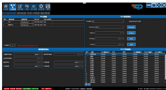
图1 PLC通讯配置界面
