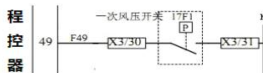
图1 技改前一次风压开关接线图
