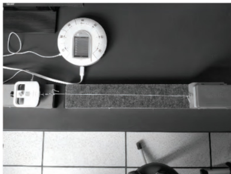
图3 测量木板摩擦力的实验装置
