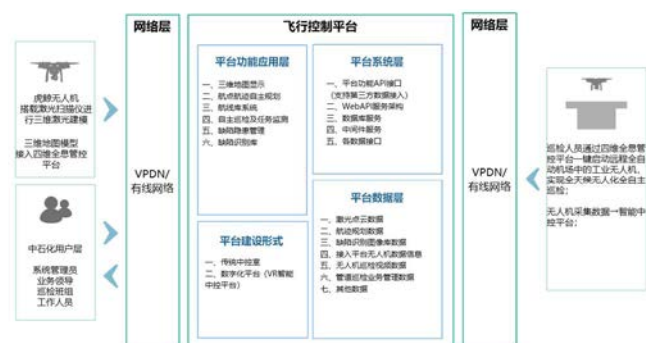
图1 无人智能巡检系统总体架构示意图
