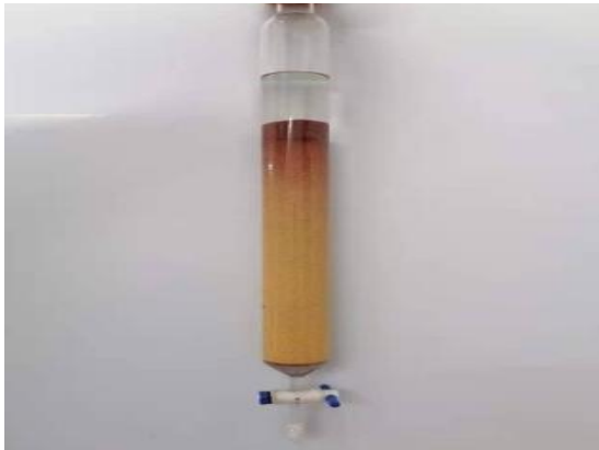
图2 离子交换柱中被包裹的树脂
