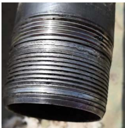
图1 发生脱扣的第10支油管外螺纹
