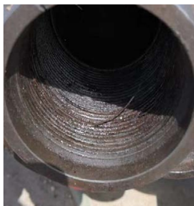
图2 发生脱扣的第11支油管内螺纹形貌
