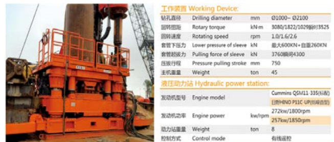
图3 全回转钻机参数表
