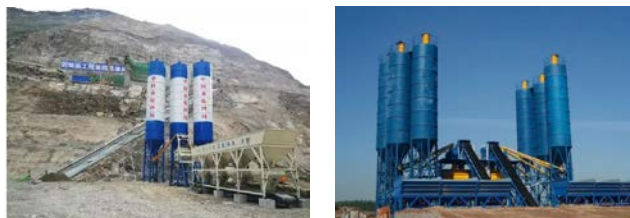
图2 水利工程混凝土搅拌
