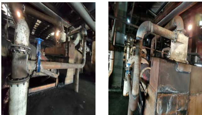
图2 并联Φ500mm水力旋流器改造后
