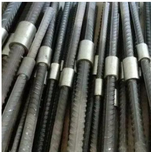
图1 热轧带肋钢筋直螺纹连接
