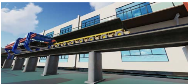
图1 高铁架桥机提运架一体化系统工程区模型渲染效果
