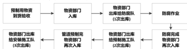
图1：传统模式下预制用物资工作流程图
