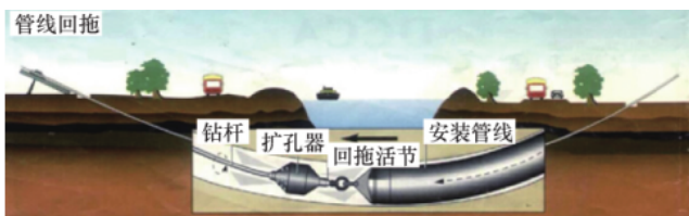
图2 管道回拖示意图
