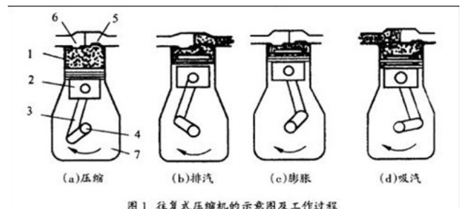
图1 往复式压缩机的示意图及工作过程
