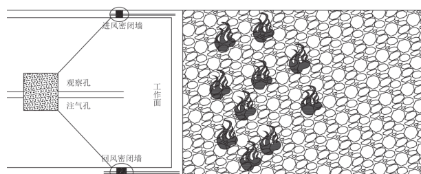
图3.1 注氮稀释与防火物理模型
