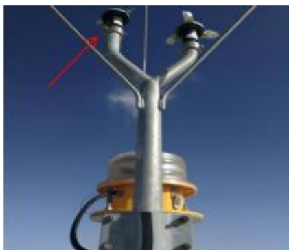
如图2 风向标对风角度修正
