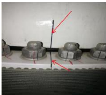
如图1 叶片机械对零位置
