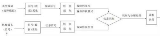
图 1 工程机械设备状态分析和故障诊断
