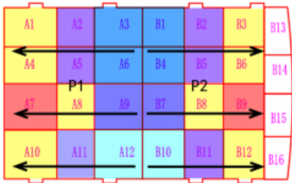
图2 钢结构施工流水段示意图
