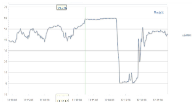
图4 R401放料时C801出口压力PI803压力变化情况
