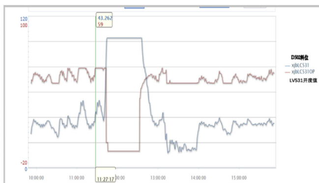
图3 R401放料时D502料位与LV531阀门开度变化
