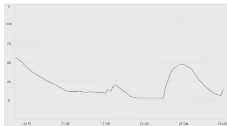
图五 低压脱丙烷塔回流罐液位
