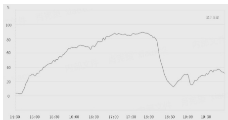
图三 低压脱丙烷塔塔釜加热
