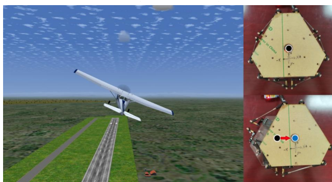
图2 X轴正向位移(飞机右转复合运动中的X轴分量)
