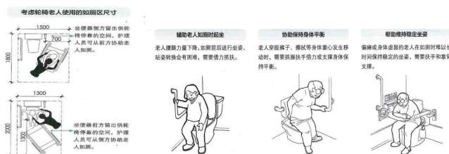
图3-1卫生间设计尺寸及扶手设计详图
