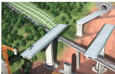
图1 转体施工示意图
