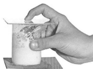
图6-2 化学反应吸热使烧杯与木片间的水凝结成冰
