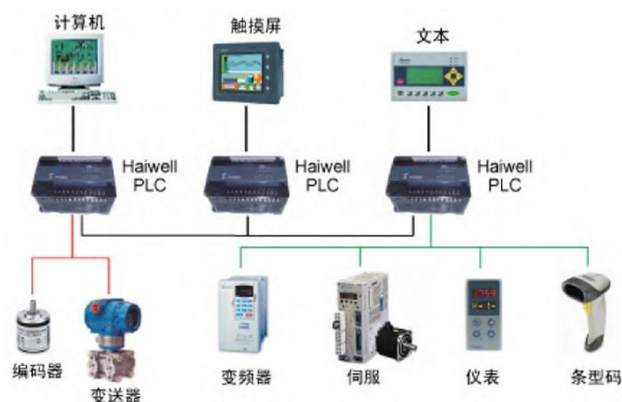
图1 现场总线的电气自动化设备结构图
