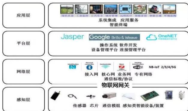
图1 安全物联网网关技术架构
