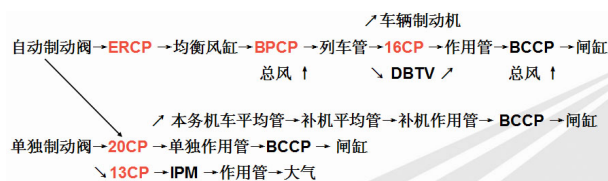
图1 EPCU控制关系
